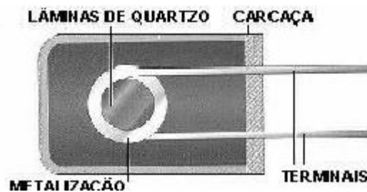
Figura 13 Vista do interior do componente Cristal de quartzo[4]
