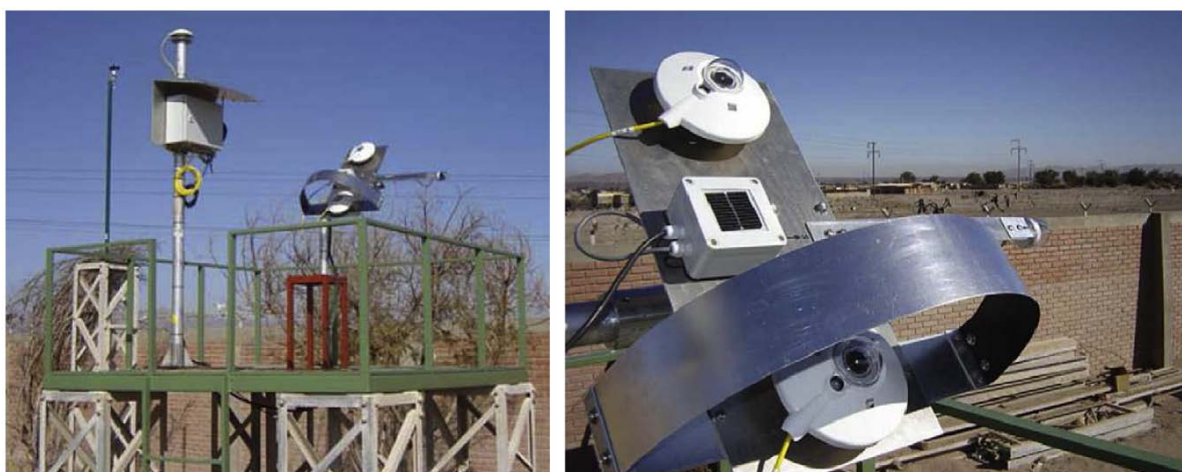
Figura 1. Vista de la estación CNE – GTZ y sus alrededores y el detalle de los piranómetros usados en el modo de “Seguimiento”
