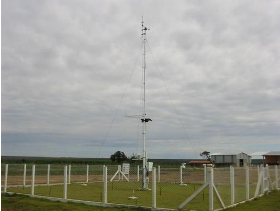
Figura 1. Estação Meteorológica de Observação de Superfície Automática – Município de Luiz Eduardo Magalhães, BA
