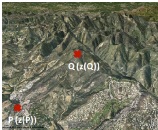
Figura 4-5: Exemplo de uma diferença de elevação de dois pontos em um pixel de satélite [Espinar et al. 2011]
