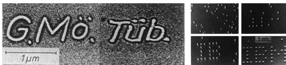
FIG. 1.1 a) Exemplo de nanolitografia datado de fevereiro de 1960. (FONTE: G. MOLLENSTEDT e R. SPEIDEL apud R. F. W. PEASE 3 ); b) Átomos de xenônio alinhados artificialmente. (FONTE: D. EIGLER e E. K. SCHWEIZER 4 )
