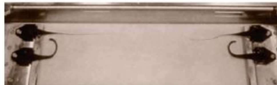
(c) Ruptura do ligante asfáltico
