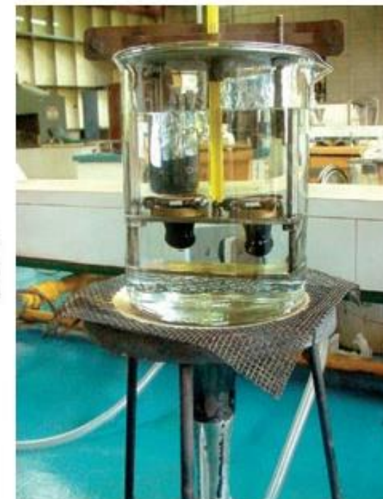
(b) Detalhe esquemático do anel e bola e equipamento manual
