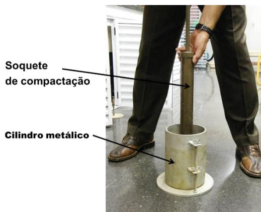
**Figura 2 (a):** cilindro e soquete de compactação
