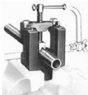
Dispositivo para corte e dobra de tubos de aço sem costura
