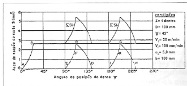
Figura 12.11 - Variação da Secção do Cavaco no Fresamento com Fresas Helicoidais: dente 1 - ABCD; dente 2 - EFGH; secção resultante - Si
