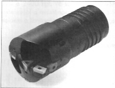
Figura 11.6 - Broca Canhão com Remoção Interna de Cavaco (BTA)
