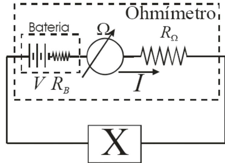
Se  $R_X \gg R_B + R_\Omega$  essa resistência pode ser desprezada e a resistência medida é aproximadamente igual a  $R_X$
