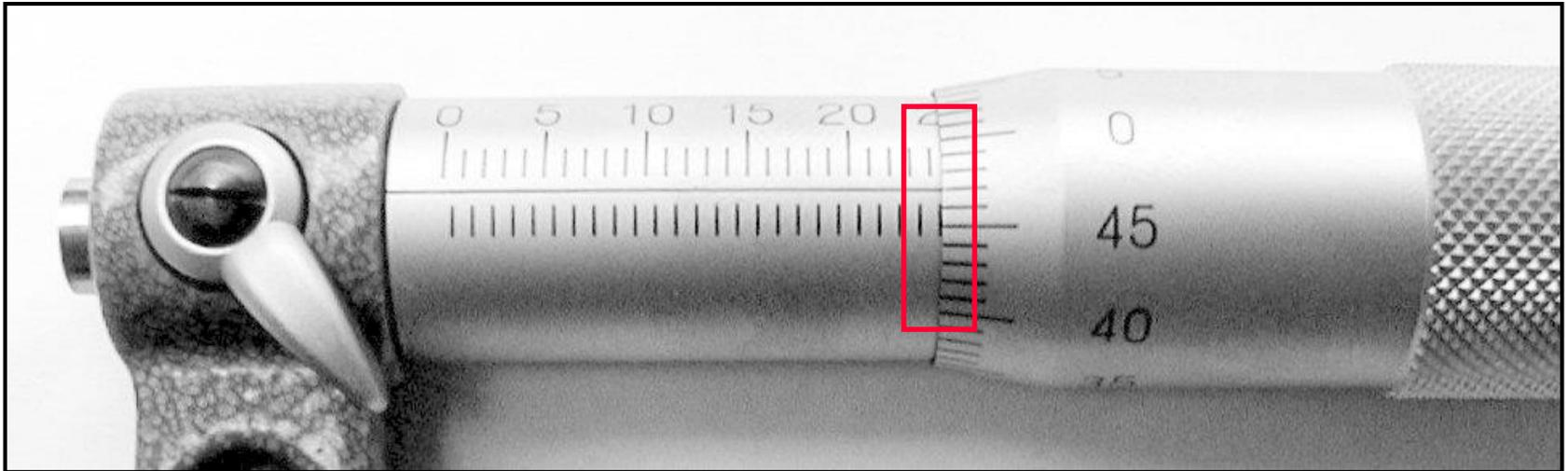
1) Posição da escala móvel (passos de 0,5 mm)
