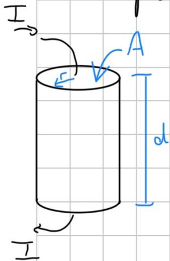
$$E = \frac{V}{d} \rightarrow \text{Campo elétrico ao longo do cilindro}$$
