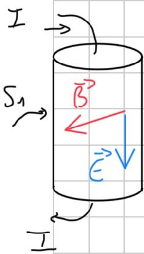
$$\vec{S} = \frac{\vec{E} \times \vec{B}}{\mu_0} \rightarrow \text{aponta para dentro do fio}$$
