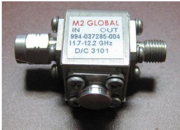
Isolador de junção triplaca conectorizado
