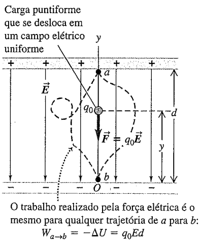
Figura 23.2 O trabalho realizado sobre uma carga puntiforme que se desloca em um campo elétrico uniforme. Compare com a Figura 23.1.
