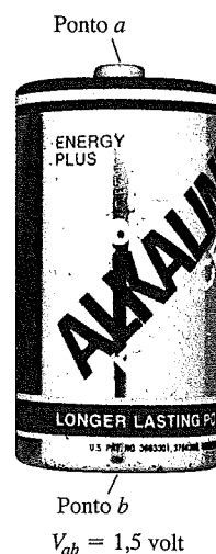
Figura 23.11 A vtagem desta pilha é igual à diferença de potencial V_{ab} = V_a - V_b entre o terminal positivo (ponto a ) e o terminal negativo (ponto b ).
