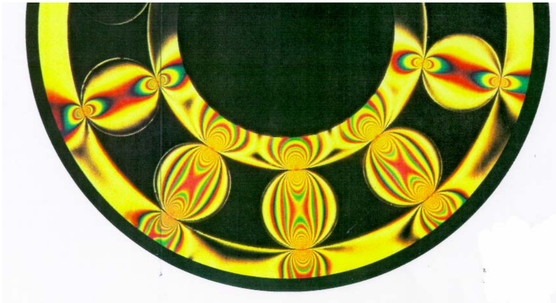
Figura 1.8 – Franjas isocromáticas num contacto rolo/pista de um rolamento [7].
