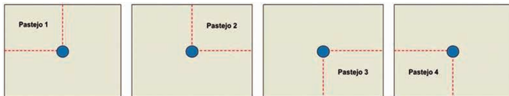
Figura 2. Exemplificação da cerca eletrificada, com fios elétricos rotativos em vermelho.
