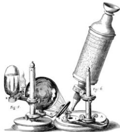
Figura 4 : Microscópio composto representado por Hooke em Micrographia .
