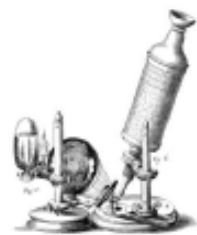
Figura 5: Microscópio composto representado por Hooke em Micrographia .
