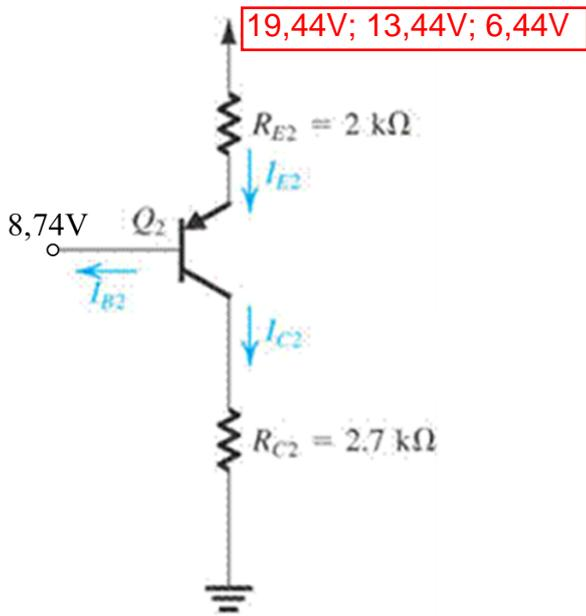
**DESAFIO: Exemplo 5.11** Desejamos analisar o circuito abaixo para determinar todas as tensões nodais e todas as correntes nos ramos. Suponha  $\beta = 100$ .
