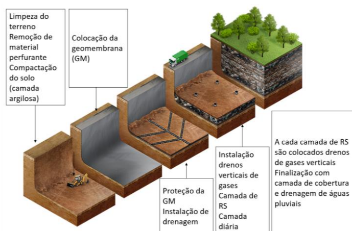
Figura 8 – Etapas da construção de um aterro sanitário
