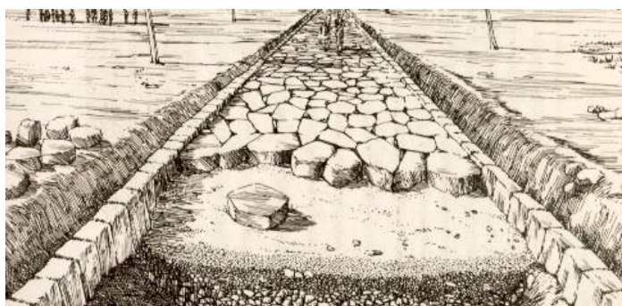
Figura 4 Detalhes da execução de uma via romana.
