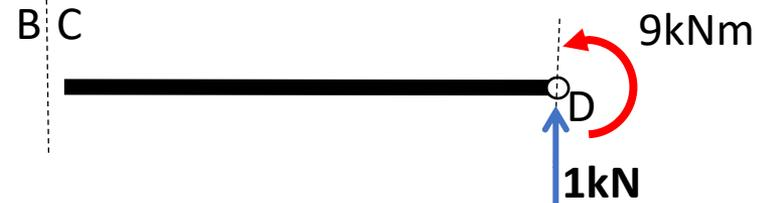
Os esforços solicitantes que atuam em uma seção transversal de uma barra podem ser obtidos cortando a barra nesta seção e reduzindo no seu centro de gravidade todos os esforços externos aplicados do outro lado do corte.
