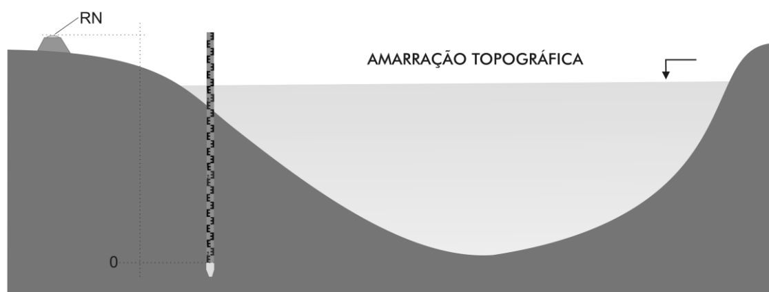
Figura 4.5- Régua linimétrica instalada em uma seção de medição.
