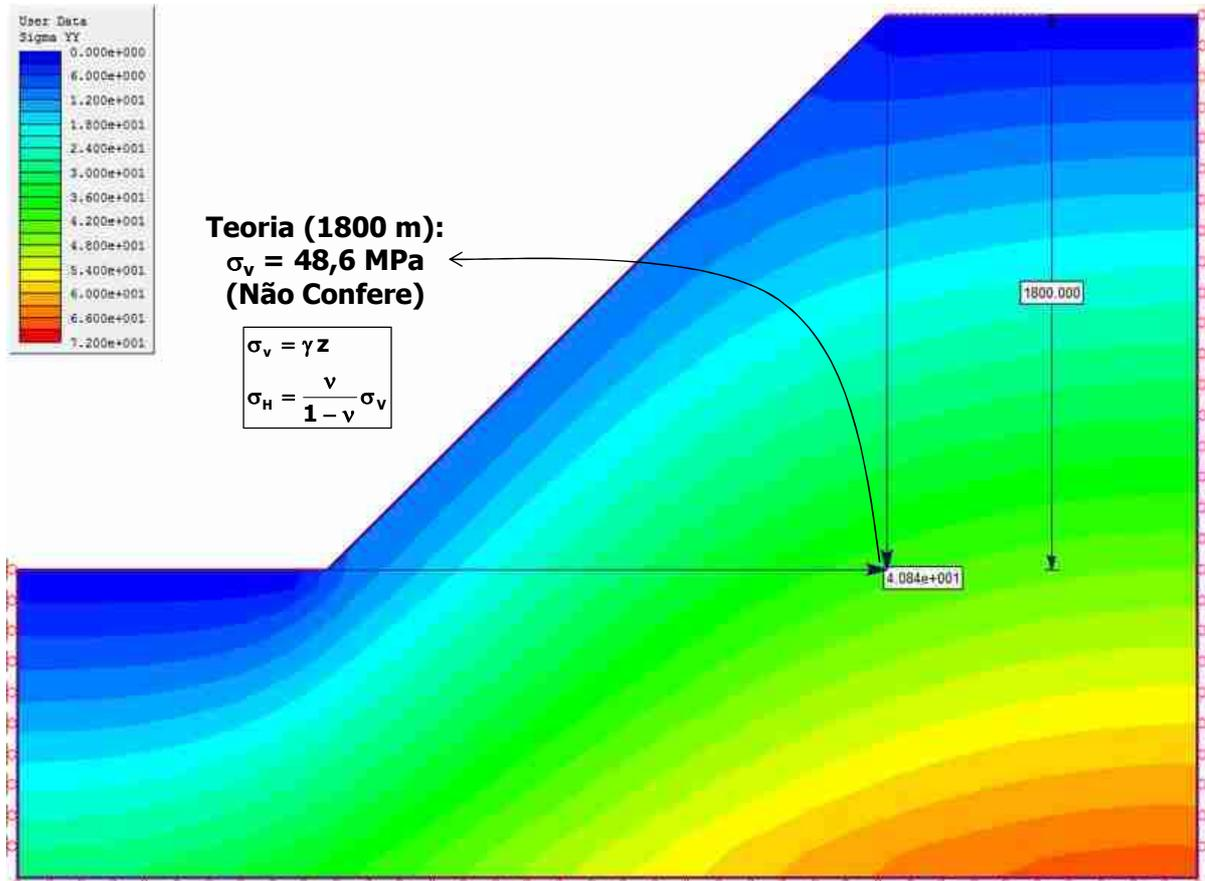
**Distribuição das tensões verticais  $\sigma_v$  em MPa em região de encosta**
