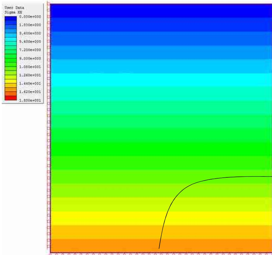
Distribuição das tensões horizontais  $\sigma_{xx}$  em MPa
