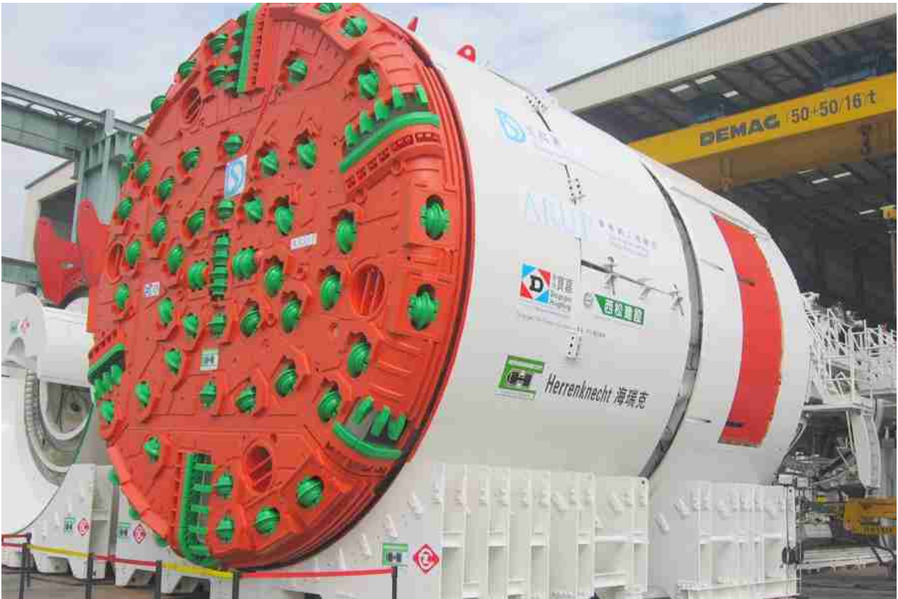
Equipamento para escavação de túneis a seção plena (TBM - Tunnel boring Machine)
