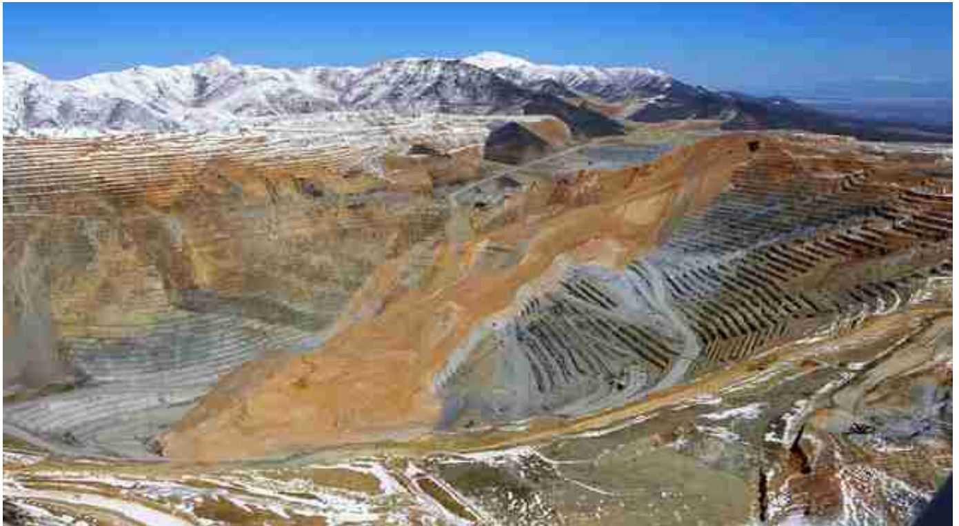
Ruptura do talude da mina Bingham Canyon (EUA) em 10/04/2013
