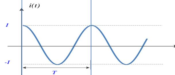
**Figura 6 – Corrente no capacitor**
