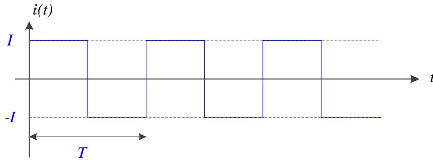
**Figura 4** – Comportamento da corrente no capacitor.
