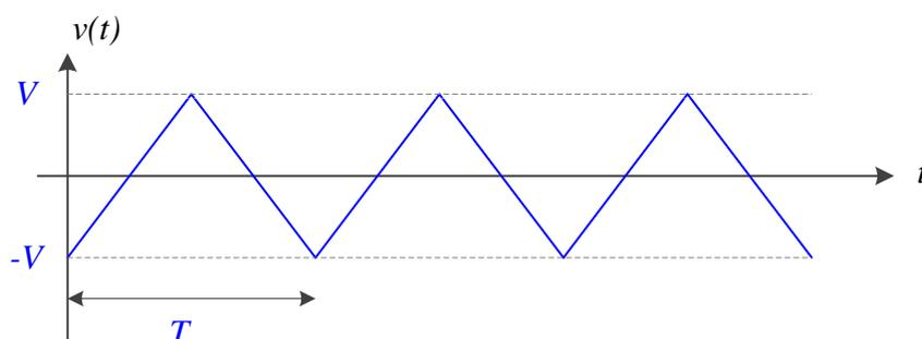
**Figura 3** – Comportamento da tensão sobre o capacitor.
