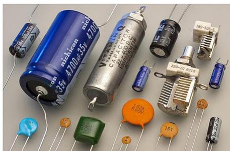
Figura 1 – Exemplos de capacitores [1]
