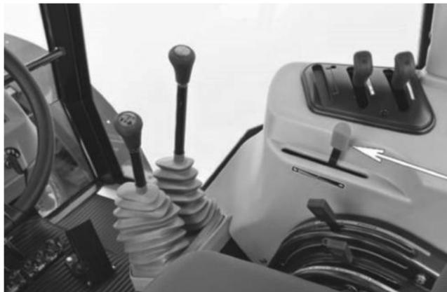
**Manual** – manter a **rotação do motor constante** e deve ser utilizado durante a operação.
