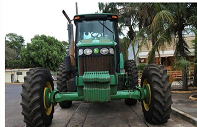
Para adequar a bitola de acordo com o espaçamento das entre linhas, produtores utilizam alongadores de eixos e alguns modelos já podem vir de fábrica com eixos alongados
