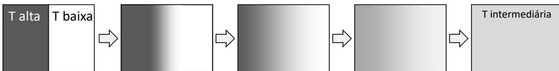
**Figura 1:** Exemplo de difusão de energia térmica em um sistema sólido até atingir o equilíbrio térmico.
