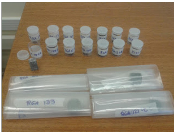
FIGURA 2.7.1: Amostras preparadas para medições de susceptibilidade magnética e magnetização natural remanescente (NRM).
