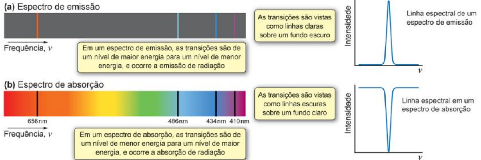
Figura 2.11 (a) Espectro de emissão e (b) espectro de absorção do átomo do hidrogênio. (O espectro de absorção apresentado é para o átomo excitado com n = 2 . Para o hidrogênio no estado fundamental, o espectro de absorção está na região ultravioleta.)
