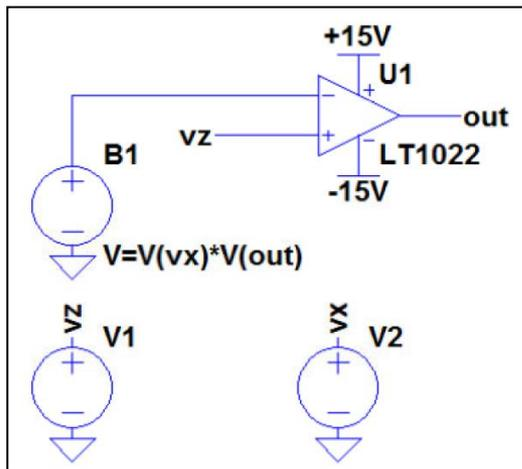
$$V_{out} = A(V_Z - V_{produto})$$
