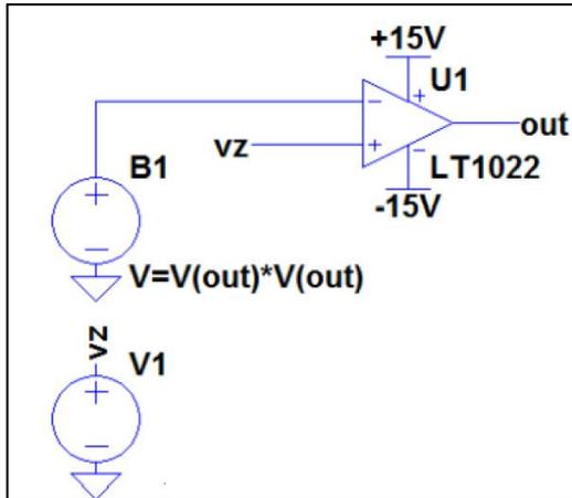
$$V_{out} = A(V_Z - V_{produto})$$
