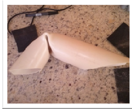
Figuras 53 e 54 – Processo de modelagem do cano de PVC com secador de cabelo
