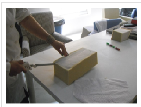
Figuras 43 e 44 – A espuma deve ser escavada com a faca elétrica ou estilete, a fim de que o segmento corporal possa ser acomodado na órtese.
