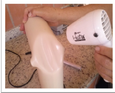
Figuras 53 e 54 – Processo de modelagem do cano de PVC com secador de cabelo
