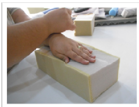
Figuras 41 e 42 – Um bloco de espuma do tamanho necessário para o doente deve ser recortado, e depois mede-se o respectivo segmento corporal.
