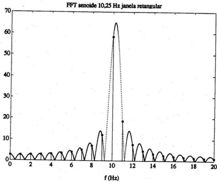
Figura 2 - Módulo do espectro da TDF de cossenóide de 10,25 Hz, truncada por janela retangular e amostrada.
