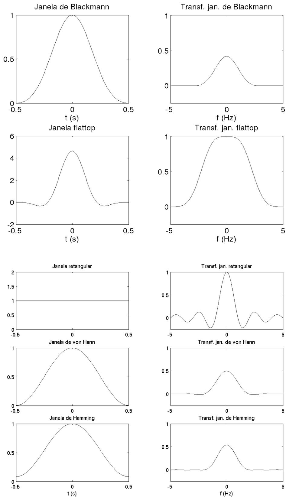
Figura 4 - Janelas usadas na experiência. (Veja na pág.17 uma comparação das transformadas das janelas, em dB)
