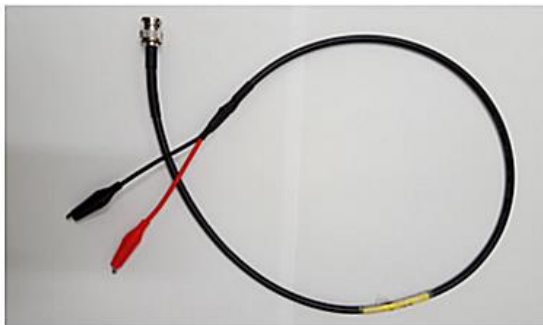
Figura 3 – Cabo coaxial com terminais BNC – jacarés e pinos para medição de v id (t).
