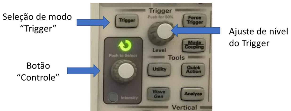
**Figura 12** – Botões para seleção de modo *Trigger* e ajuste do nível de *Trigger*
