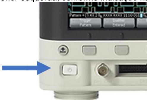
Figura 2 – Botão para ligar ou desligar o osciloscópio.
