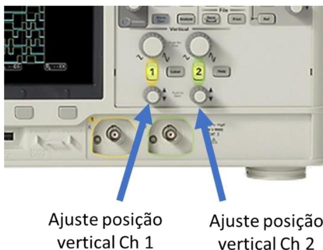
Figura 6 – Botões de ajuste de posição vertical do sinal na tela do osciloscópio.
