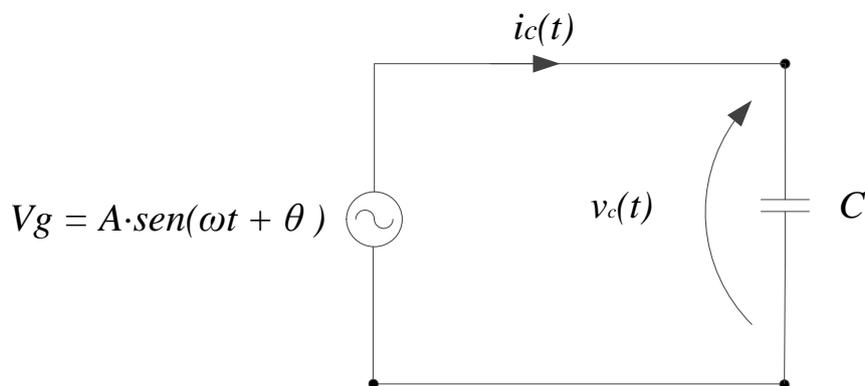
**Figura 3** – Carga capacitiva alimentada por uma fonte alternada.
