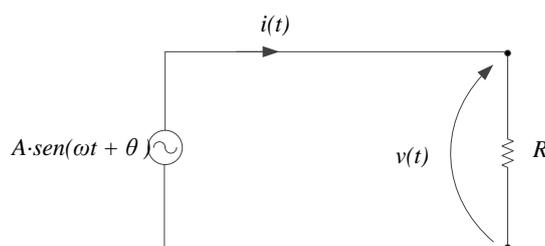
**Figura 2** – Carga resistiva alimentada por uma fonte alternada.
