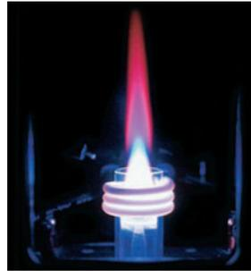
Um **plasma** é um gás quente parcialmente ionizado, que contém uma concentração relativamente alta de elétrons e íons.
