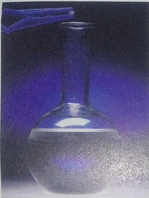
Um cristal acetato de sódio, \text{CH}_3\text{COONa} , prestes a ser adicionado a uma solução supersaturada desse sal em água.
