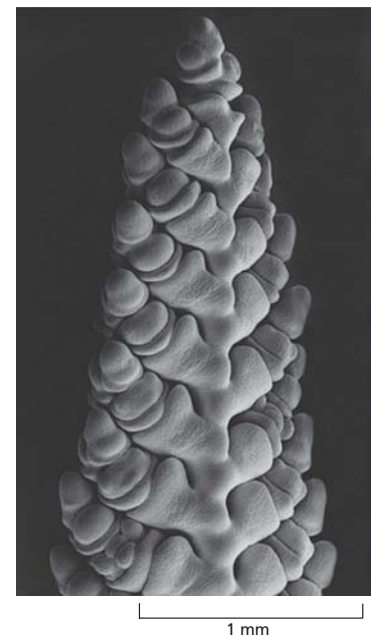
Figura 9-49 Flor – ou espiga – de trigo em desenvolvimento. Esta delicada flor foi congelada rapidamente, coberta com um fino filme de metal e examinada no seu estado congelado com um SEM. Esta micrografia de baixa magnitude demonstra a grande profundidade de foco de um SEM. (Cortesia de Kim Findlay.)
