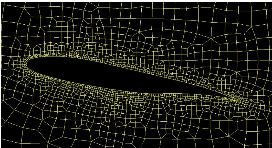
Figura 1: Exemplo de discretização espacial bidimensional para o estudo aerodinâmico de uma seção de aerofólio.
