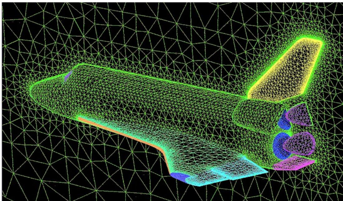
Figura 2: Exemplo de discretização espacial tridimensional para o estudo aerodinâmico do ônibus espacial. Só aparece a malha nas superfícies mas a malha computacional ocupa todo o volume do domínio com elementos tetrahédricos.
