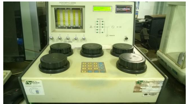
Figura 2 Pentapicnômetro Pentapyc 5200e. Observar os cinco compartimentos para inserção de amostras friáveis para coleta de dados de densidade. A proposta é a medição da densidade de partículas.
