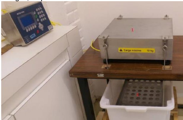
Figura 1 Balança Toledo IND-560 utilizada para medidas de densidade. 1- Base a seco; 2-Base imersa; 3-Painel de valores da amostra em questão.
