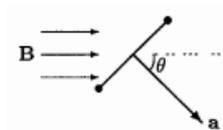
A figura mostra o arranjo visto de cima. Como o campo é uniforme, sendo  $\mathbf{A}$  um vetor perpendicular ao loop cujo módulo é sua área, o fluxo é dado por:
