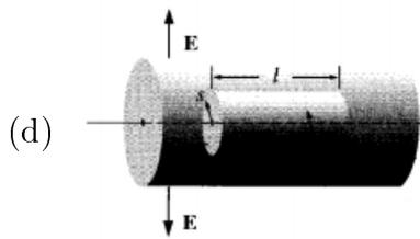
Como  $\mathbf{E} = E(s)\hat{s}$ , escolhemos como superfície gaussiana um cilindro de raio  $s$  e comprimento  $l$ , com o mesmo eixo do cilindro do problema, conforme a figura (representando o caso  $s > S$ ), então:
