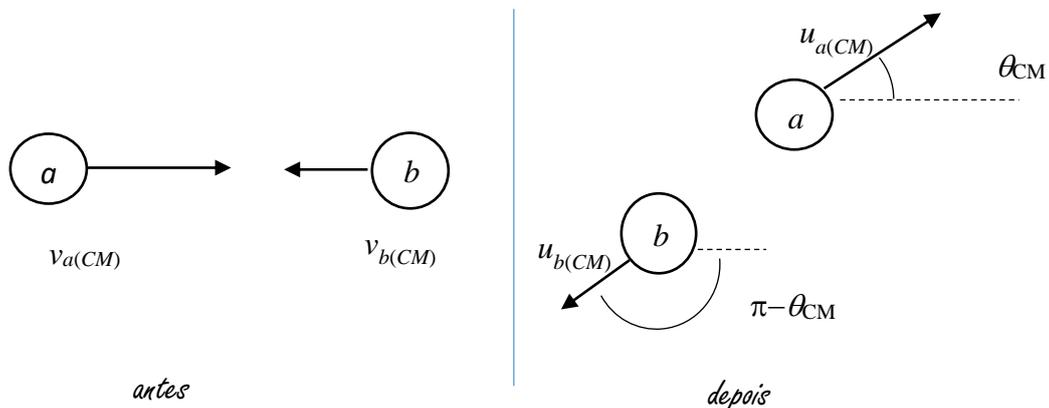
**Figura 3.** Mesmo que na figura 2, mas observado no referencial de Centro de Massa. Aqui os ângulos em que as partículas *a* e *b* são desviados somam  $\pi$  rad, necessariamente, para que a quantidade de movimento total do sistema *a*+*b* continue nula, conforme equação (10.8).
