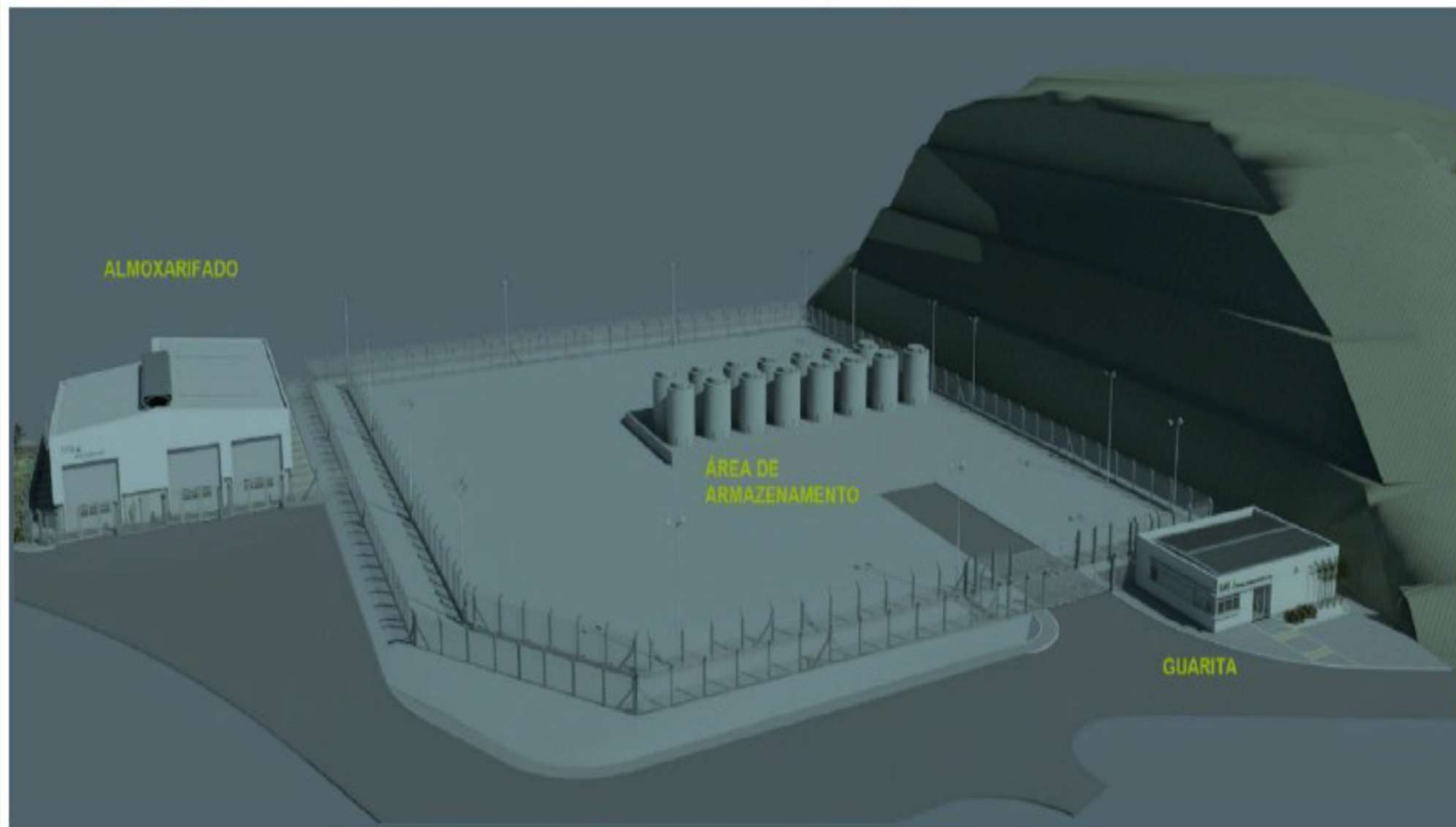
Figura 4-21 - Representação esquemática da Unidade de Armazenamento Complementar a Seco (UAS) de Elementos Combustíveis Irrradiados (ECIs)
