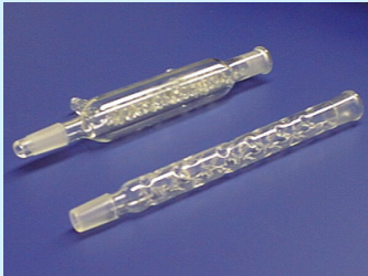
Colunas de fracionamento (a de baixo é de Vigreux)
