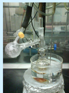
Dimetil Sulfóxido (DMS) entra em ebulição a 189°C. Sob vácuo ele destila a apenas 70°C.
