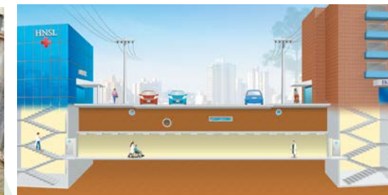
Figura 9 - Túnel sob via pública para interligação entre prédios hospitalares, com 3,64m de diâmetro.
