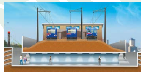
Figura 10 - Túnel urbano de pedestres sob ferrovia, com seção de 10,0m².
