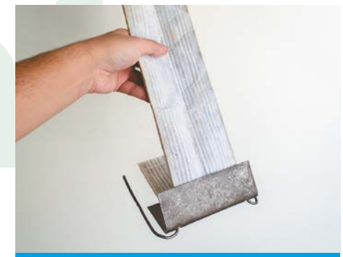
Figura 5 - Detalhe de ponteira metálica presa ao geodreno.
