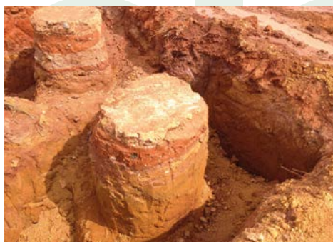
Figura 3 - Colunas escavadas - Aferição de diâmetro.
