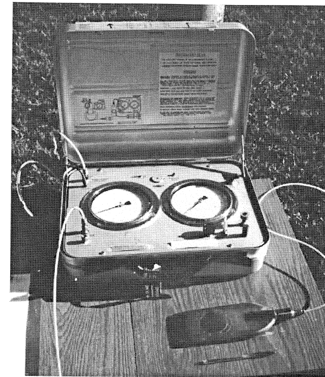
Figura 6.1 Vista do equipamento para a realização de ensaios dilatométricos
