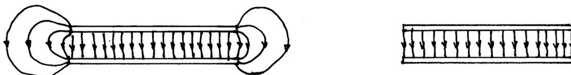
Figura 18.2: O campo elétrico de um capacitor de placas paralelas: (a) situação real; (b) modelo adequado quando  $R \gg a$ .
