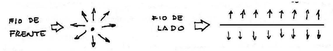
Figura 15.5: Representações do campo elétrico do fio infinito: à esquerda o fio de frente; à direita o fio de lado.
