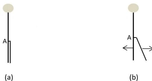
Figura 4.16: Esquema de um eletroscópio (a) descarregado e (b) eletrizado; no ponto A existe uma articulação que permite o movimento da haste da direita.
