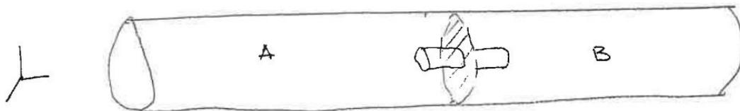
Figura 25.4: Um corpo metálico composto por dois cilindros de metais diferentes, coaxiais e justapostos
