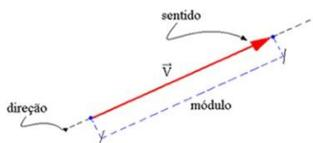
**Figura 1. Representação de um vetor por uma flecha e a correspondência com a representação por módulo, direção e sentido. O sentido vai da ponta da pena (não desenhada) à ponta da seta**
