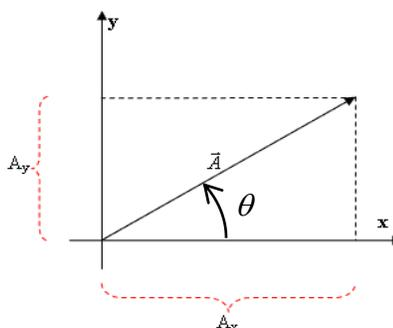
**Figura 11. Decomposição do vetor a partir de sua intensidade, direção e sentido, para determinar sua representação analítica.**
