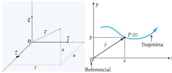
Figura 10. Representação do vetor posição  $\vec{r}$  (esquerda) e exemplo de uso do vetor posição para descrever uma trajetória (direita).
