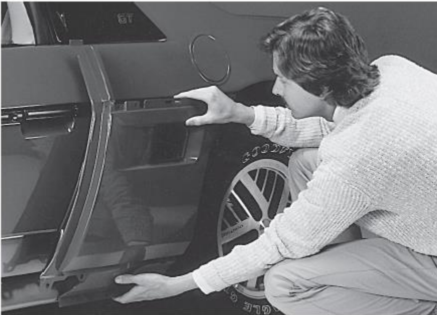
Figura 1.13 O painel traseiro nesse carro esportivo foi uma aplicação pioneira de um polímero de engenharia em uma aplicação metálica estrutural tradicional. O polímero é um náilon moldado por injeção. (Cortesia da Du Pont Company, Engineering Polymers Division.)
